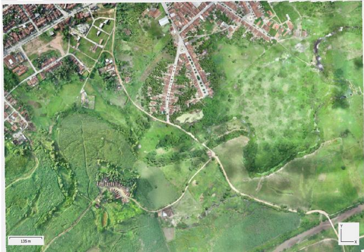
Figura 40 - Ortoimagem resultante do processamento aerofotogramétrico.
